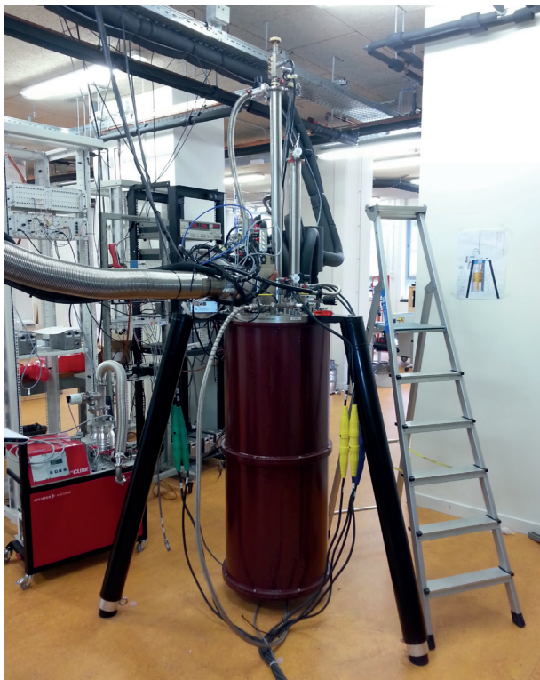
Figuur 2 De buitenste kan van de meetopstelling die uiteindelijk in de kern 10 mK wordt. Links en midden achter is een grijs en zwart meetrek zichtbaar met apparatuur waarmee stroompjes tot wel 50 femtoampère worden gemeten.
