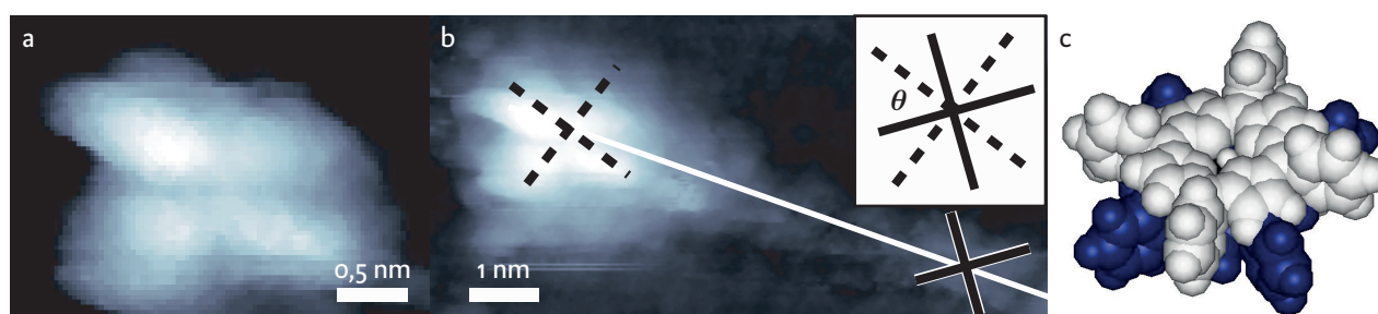
Figuur 5 a) Hogeresolutie-STM-meting van de zeer heldere toestand die de submoleculaire structuur van de porfyriene laat zien. b) Het gestippelde kruis geeft de oriëntatie van het porfyriene centrum aan in de zeer heldere toestand en het doorgetrokken kruis in een nabije normale toestand. De witte lijn verbindt de centra van deze moleculen. Inzet: de indicatie van de hoek \theta tussen de twee oriëntaties van ongeveer 45^\circ . c) Computermodel van een door een zuurstofatoom gebrugde 'dubbeldekker' van mangaanporfyrienen (de koolwaterstofstaarten zijn weggelaten).
